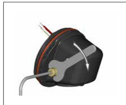
**6.** S'assurer que le corps du capteur de température est complètement inséré dans le connecteur du presse-étoupe. Serrer le connecteur du presse-étoupe.
