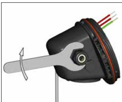
**8.** Installer le presse-étoupe électrique M25 dans l'entrée fileté M25. (Fourni par le client)
