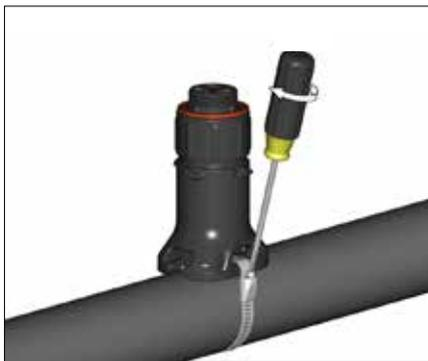
**2.** Monter le dispositif d'évacuation sur le tuyau à l'aide d'un collier de serrage.
