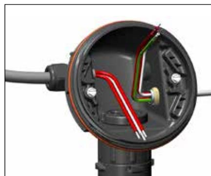
**9.** Installer le câblage de commande (fourni par l'utilisateur, 6 mm<sup>2</sup> max). Il est recommandé d'utiliser 3 câbles métalliques (pour 1 capteur) ou 6 câbles métalliques (pour 2 capteurs) avec un blindage tressé raccordé à la terre.
