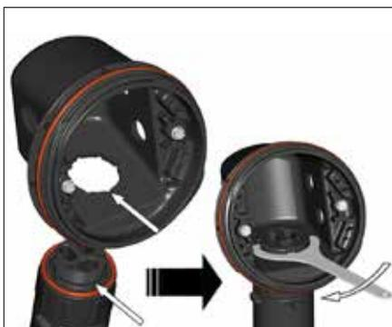
**4.** Fixer la base du boîtier de jonction sur le dispositif d'évacuation. Veiller à aligner les fentes pour bien orienter la base du boîtier de jonction. Serrer l'écrou à l'aide de l'outil Terminator-LN. Si le montage se fait horizontalement, les trous filetés du presse-étoupe doivent être dirigés vers le bas.
