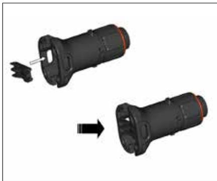
**1.** Insérer le guide de cerclage dans le dispositif d'évacuation et enclencher.
